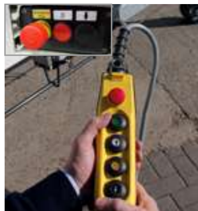
Télécommande électrique avec démarrage en douceur (commande proportionnelle)
